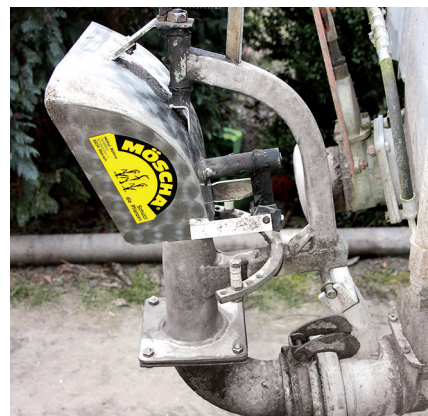
Wegen des passiven Antriebs durch den Güllestrom kann auf bewegliche Teile verzichtet werden (siehe auch Foto oben).
