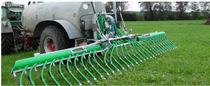
© Möscha GbR Das Möscha Verteilgestänge mit Kunststoffrohr als tragendem Konstruktionselement zeichnet sich durch seine einfache und gewichtssparende Konstruktionsweise aus.
