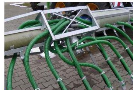
© Möscha GbR Eine vertikale Schnecke, die ihre Drehrichtung ändert, verteilt die Gülle auf die ringsum geschweißten Auslässe.
