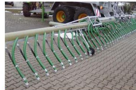
© Möscha GbR Möscha kommt zu leichteren Gestängegewichten, indem beplankte Kunststoffrohre genutzt werden.
