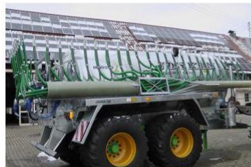
© Möscha GbR Das zweiachsige Joskin Güllefass mit 12.000 l Fassungsvermögen ist eines der ersten Fässer, das von Möscha mit der neuen Gülle-Verteiltechnik in 15 m Arbeitsbreite ausgestattet wurde.
