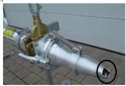
Die Bandbreite der Außendüsen wird durch Verdrehen des Ausschnitts (siehe Kreis) eingestellt.
